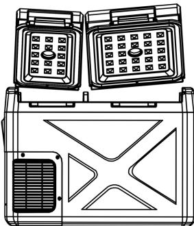
Richten Sie die Türwelle auf einer Seite an der Bohrung aus und setzen Sie sie ein.
